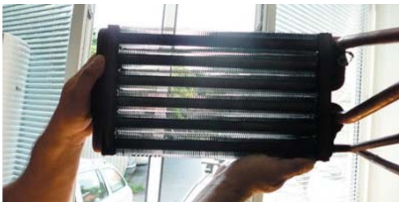
Obr. 7 - Pohled proti světlu na výměník po vyčištění lamel výměníku
