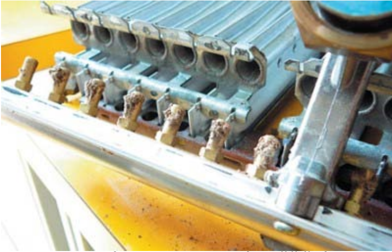
Obr. 4 - Detailní pohled na vyjmuté znečištěné trysky z difuzoru
